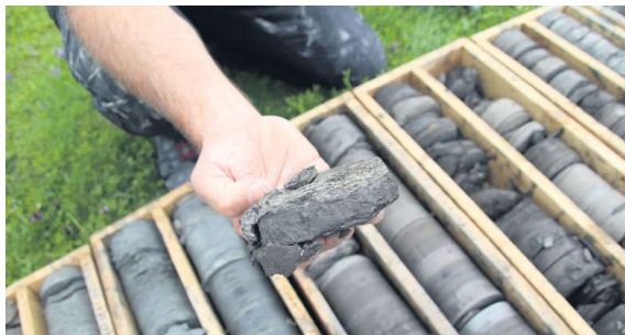
In Reih und Glied liegen die Bohrkern in Holzkisten. Patrick Blau zeigt ein Beispiel für Fischschiefer.
